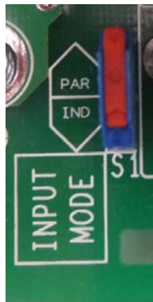
Figure 3-14: S1 Switch in PAR position (parallel mode)
